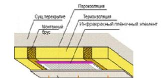
Обогрев для пола. Она устанавливается под паркетный пол. Температура поверхности фольги мала, она также может быть установлена в паркетный пол.
